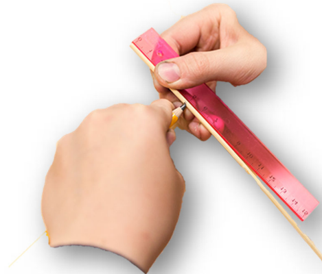
Kuva 4: Aputikkuun merkitään viivalla kohdat 5 cm ja 3,4 cm etäisyydelle kärjestä.
