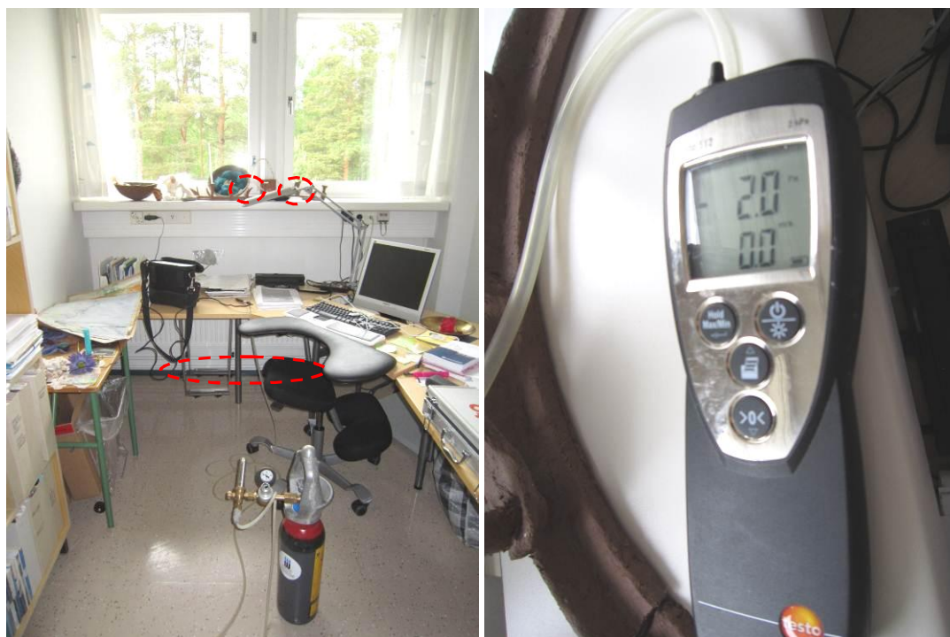
Kuvat 18 a ja b. Tilassa D203 havaittiin ilmavuotoa lattianrajassa sekä vähäistä ilmavuotoa ikkunan karmiliitoksissa, kohdat on merkitty kuvaan punaisella katkoviivalla. Tilassa mitattiin ulkoseinän yli 2...6 Pa alipaine.
