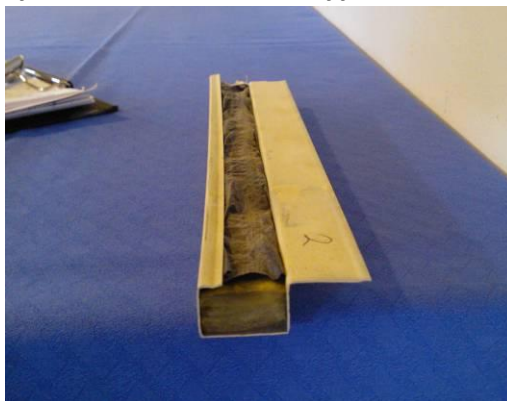
Kuva 23. Sisääntuloaulan (C125) alaslasketuissa katoissa on muovipinnoitettua mineraalivillaa. Villan päät ovat pinnoittamatta.
