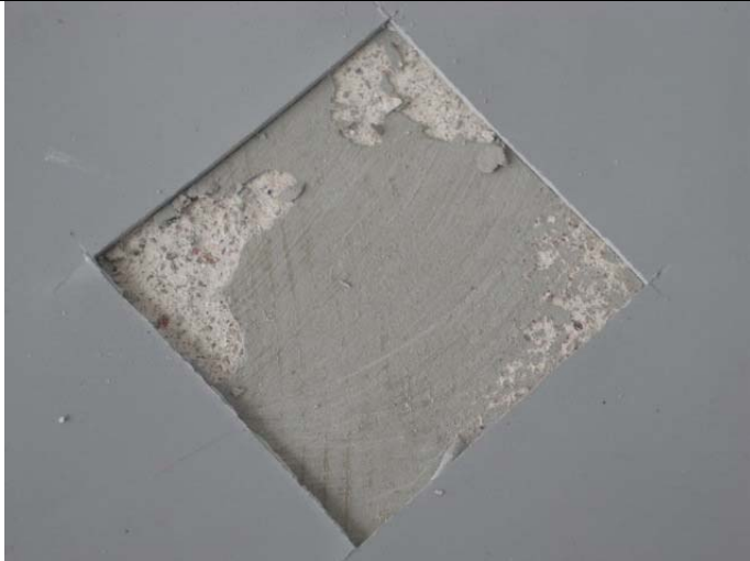
Kuva 3. Materiaalinäyte otettiin irrottamalla noin 5 x 5 cm 2 pala mattoveitsellä tutkittavaa pinnoitetta. Näyte käärittiin heti folioon.
