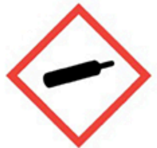
paineen alainen kaasu gas under pressure
