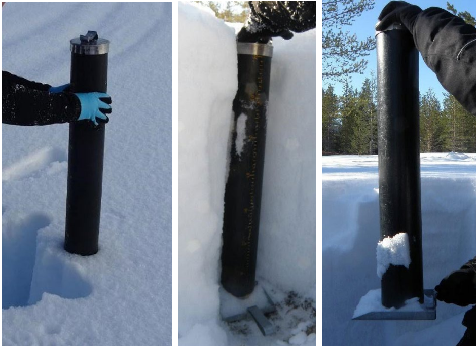
Kuva 4: Lumen vesiarvon ja tiheyden mittaaminen putkella. Luminäyte siirretään putkesta pussiin ja punnitaan vaa'alla. Ota useampi näyte päällekkäin, jos lunta on putken pituutta enemmän.
