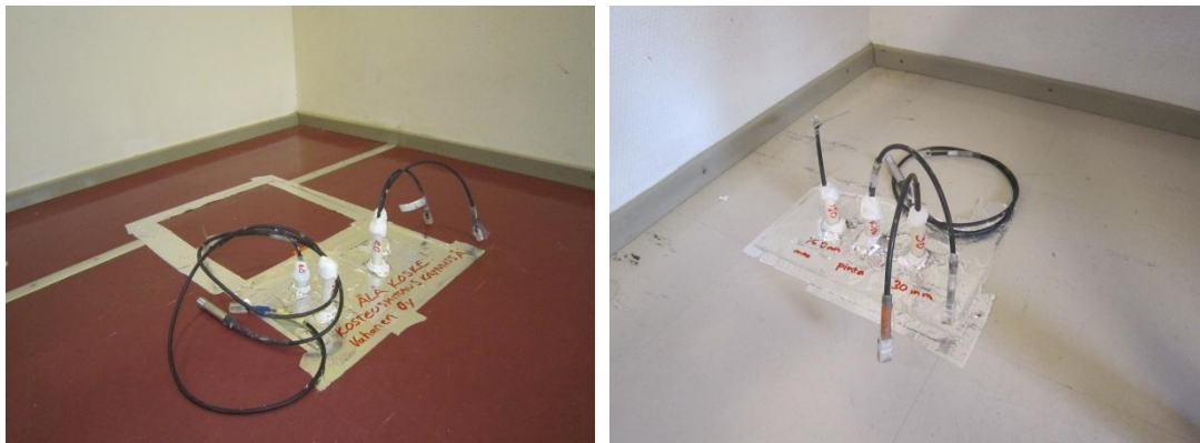
Kuva 12. Alapohjan rakennekosteus mitattiin porareikämenetelmällä kopiohuoneesta (RKM1) ja huoneesta B114 (RKM2).
