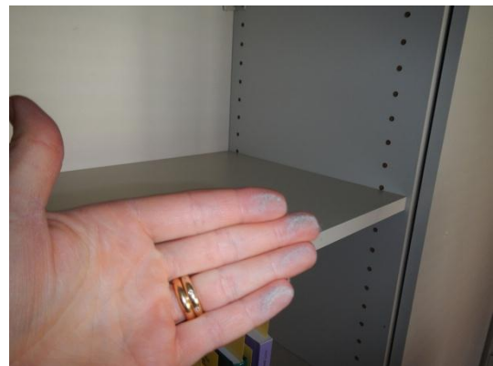
Kuva 76. Tutkituissa tiloissa oli sisäpinnoilla tavanomainen määrä laskeutunutta pölyä. Heikosti siivottuja paikkoja olivat mm. patteriritilöiden aluset ja paikoin korkeat tasot ja kaikki laskettujen kattojen päälliset.
