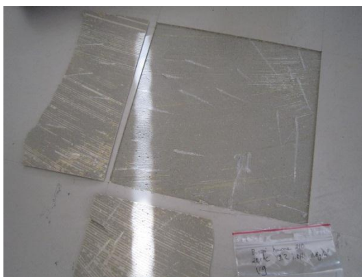
Kuva 42. Huoneen B210 lattiapäällystettä irrotettiin alustan kunnan tarkastamiseksi (Ra 2.10). Liimakerros oli reuna-alueilla kellertävää, mutta selviä, poikkeavia hajuja ei havaittu. Tasoitekerroksessa oli havaittavissa pieniä kuplien aiheuttamia koloja.
